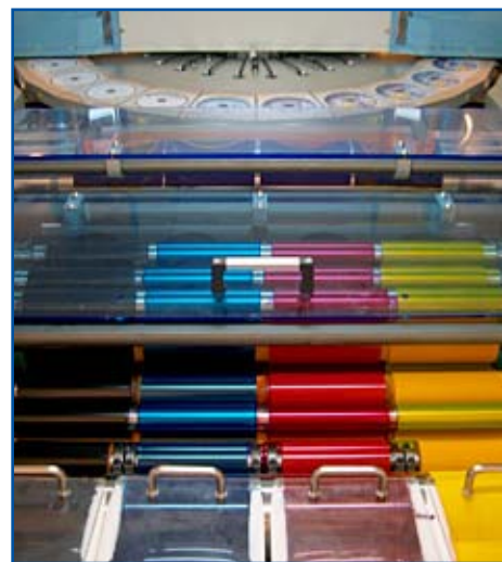
Rechts: Farbwerke einer CD-/DVD-Offsetdruckmaschine Unten : Vorderer Teil der Druckmaschine mit (von links) Disk-Karussell, Druckplatte und Zylinder mit Gummituch.
