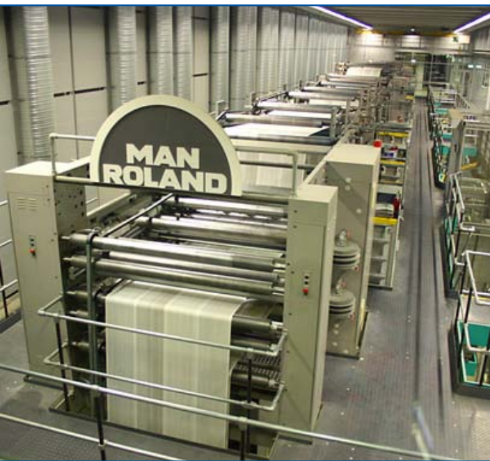
Oben: Moderne Rollenoffset-Druckmaschine, die üblicherweise im Zeitungsdruck Verwendung findet
