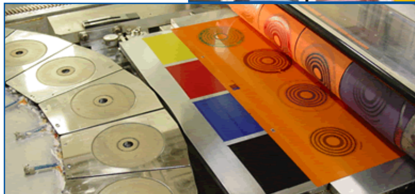
Rechts: Farbwerke einer CD-/DVD-Offsetdruckmaschine Unten : Vorderer Teil der Druckmaschine mit (von links) Disk-Karussell, Druckplatte und Zylinder mit Gummituch.
