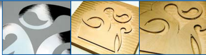
Schematische Darstellung Prägefoliendruck, plan Unten links: Ergebnis Unten Mitte: Prägedruckform Unten rechts: Prägedruckform (Microembossing)
