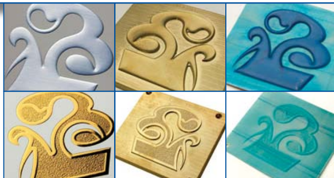
Reihe unten: Unten links: Ergebnis Prägefoliendruck (Struktur) Unten Mitte: Prägedruckform (Struktur) Mitte rechts: Gegendruckform/Patrize (Struktur)
